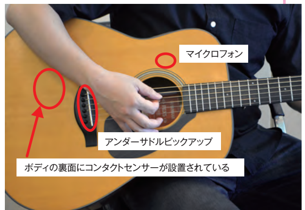
従来のエレアコとの音色の違いは素人でもはっきり分かる。マイクロフォン、アンダーサドルピックアップ、コンタクトセンサーが一体となった3ウェイピックアップシステムの成果だ（赤丸は設置位置のイメージ）
